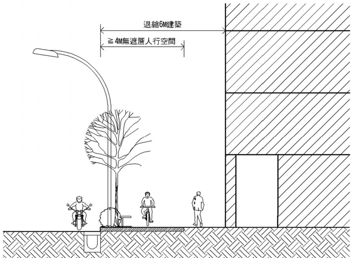
圖 5-6 退縮 6M 建築之斷面設計圖
